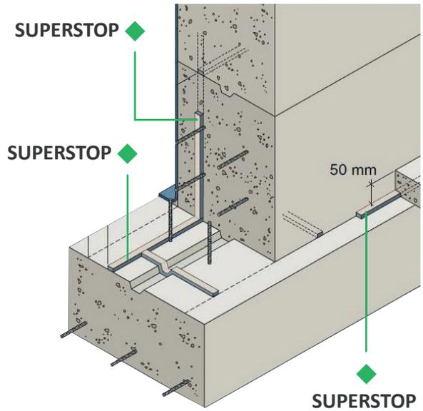
**¿Como se instala SUPERSTOP en ductos o piezas que atraviesen el hormigón?**
